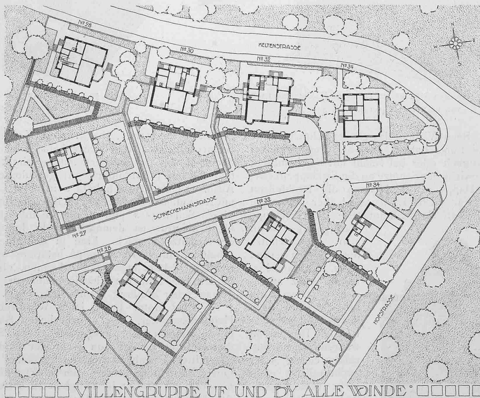
Abb. 1. Lageplan mit Erdgeschoss-Grundrissen. — 1 : 1000.
