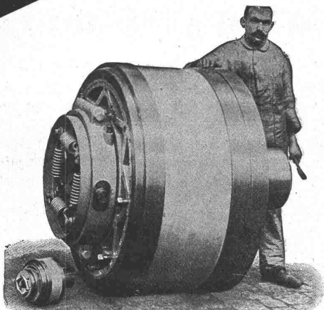
Benn Kupplung Nr. 12 für 600 PS geliefert in eine Zementfabrik.
