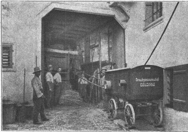
Dreschmaschinenantrieb mit Oerlikonmotor.
