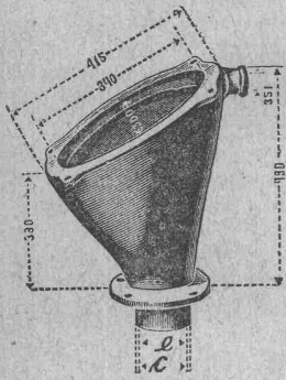
Fig. R 790 aus Gußeisen emailliert e = 110 mm c = 120 „ Nettogewicht ca. 19 kg
