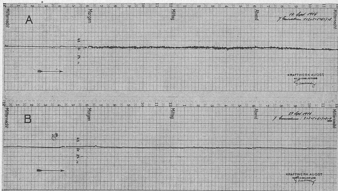
Abb. 30. Frequenzmesser-Aufnahmen bei Vergleich-Versuchen im Kraftwerk Augst auf normale Netzbelastung: A Betrieb mit sieben Maschinen mit bisherigen Regulatoren; B Betrieb mit sechs Maschinen mit bisherigen und einer Maschine mit neuem Regulator.
