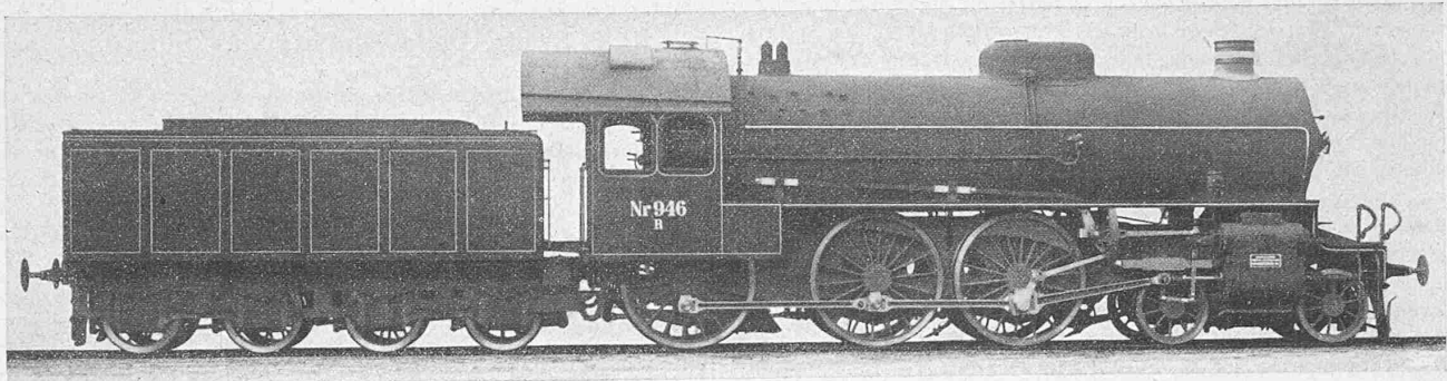
Abb. 2. 3/4 gekuppelte Heissdampf-Schnellzuglokomotive, Klasse F, der Dänischen Staatsbahn.
