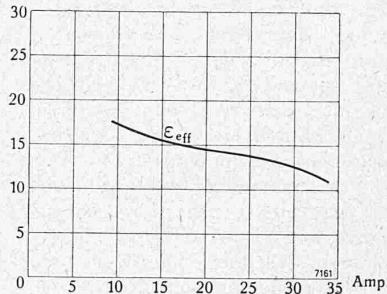
Abb. 11. Effektiver Spannungsabfall in der Dampfstrecke; aus direkter wattmetrischer Verlustmessung berechnet.
