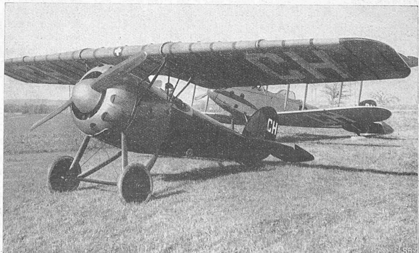
Abb. 29. Deutsches Jagdflugzeug Typ „Verspannungslos“ („Parasol“) in Dübendorf. (Abb. 29, 32 und 33 sind Aufnahmen von Flieger-Leutnant Mittelholzer der „Ad Astra-Aero-Ges.“)
