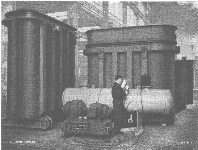
Mit Brown Boveri Lichtbogen-Schweißgruppen elektrisch geschweißte Groß-Transformatorenkessel.
