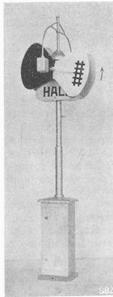
Abb. 8. Automat. Drehflügel-Signal der Hasler A.-G., Bern.
