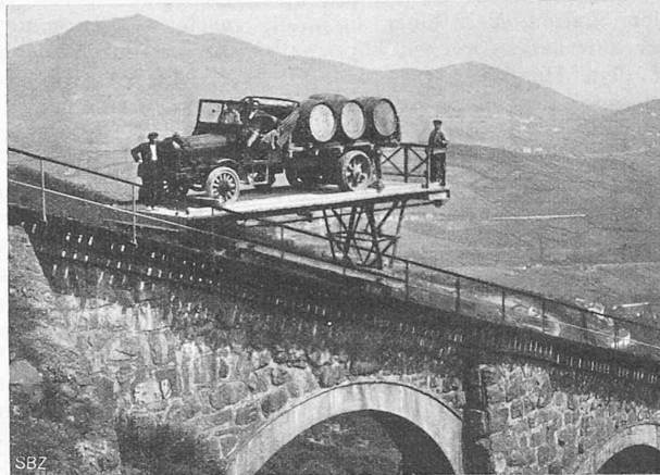
Abb. 2. Wagen mit Plattform für Automobiltransport.
