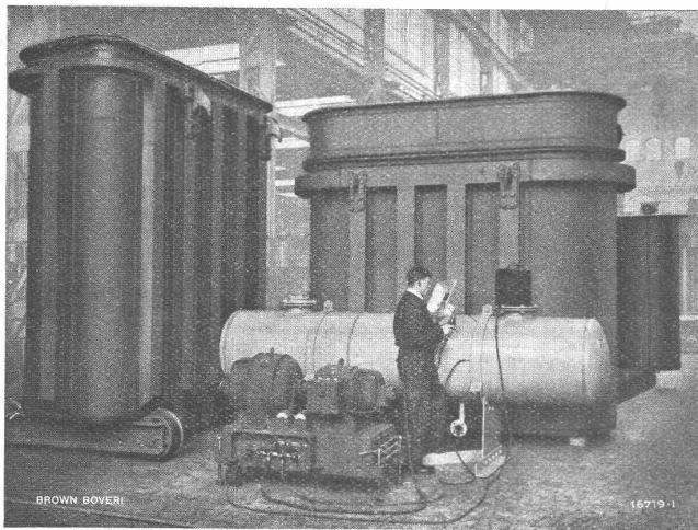
Mit Brown Boveri Lichtbogen-Schweißgruppen elektrisch geschweißte Groß-Transformatorenkessel.
