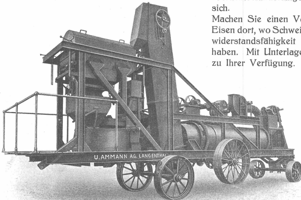
Walzasphalt - Aufbereitungsanlage Leistung 6-12 T/Std. Heiztrommel und andere Teile aus Armco-Eisen. Hersteller: U. Ammann A. G., Langenthal
