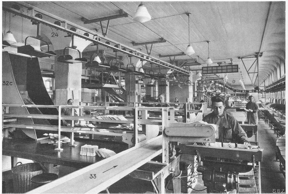
Abb. 25. Briefversand: Ausmündung des Kippkübelaufzugs, Einstelltische mit Stempelmaschinen, Schaukelförderer.
