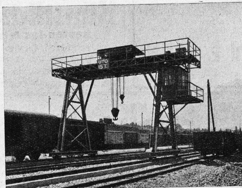
Fahrbarer Bockkran mit zwei Hubwerken
