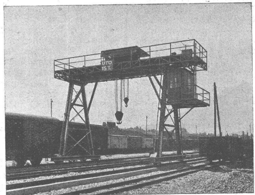
Fahrbarer Bockkran mit zwei Hubwerken
