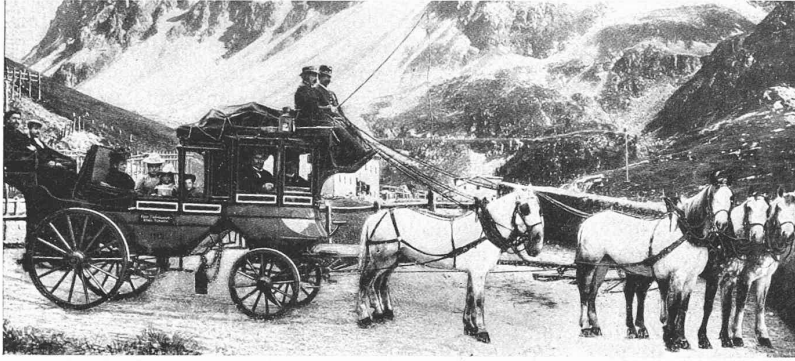
Abb. 18. Die Schweizer Alpenpost beförderte auf 10‰ mit „5 PS“ acht Reisende mit 9 km/h. Vor 1830 (Vollendung der Gotthardstrasse) förderte bis 30‰ das Sauntier 1/10 t Last mit 4 km/h.
