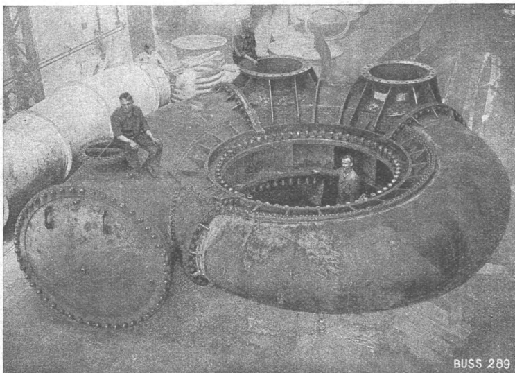
Spiralgehäuse einer Turbine, Durchmesser des Einlaufes 1900 mm, sich reduzierend auf ca. 1000 mm, Betriebsdruck 8 Atm., Prüfdruck 14 Atm.
