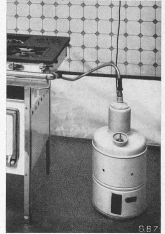
Abb. 1 u. 2. Schema und Ansicht des „Aerogaserzeugers“.
