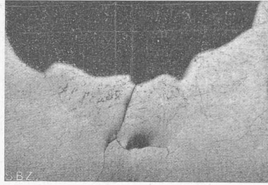
Abb. 26. Mikrophotographie eines korrodierten Messings mit interkristallinen Rissen. 50 fach.
