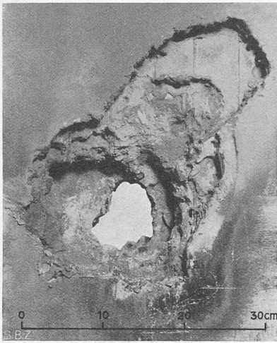
Abb. 2. Durchbrenn-Versuche der EMPA, Wirkung nach 8 h 35 min Brenndauer.
