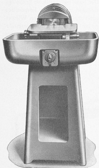
Abb. 4. Diamantscheiben-Schleifmaschine (Fritz Wunderli, Uster).
