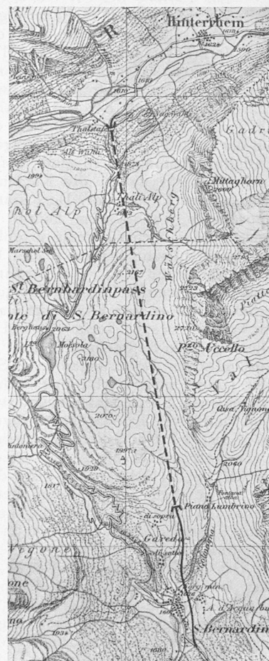
Abb. 19. St. Bernhard mit Passtrasse und projekt. Tunnel von 5,1 km, Südportal-Kote etwa 1700. — Masstab der Karte 1 : 65 000.
