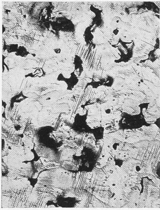
Abb. 8. Randgebiet der Beanspruchungsfläche von Guss-Bronze (G B 12). Die Gleitlinien liegen vorzugsweise um die Mikrolunker. Abb. 8 bis 11 Vergrößerung 100-fach.
