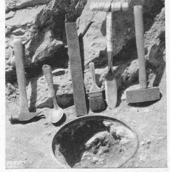
Abb. 17. Probeloch und zugehörige Werkzeuge
