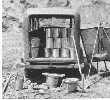
Abb. 16. Materialprüfungswagen mit Geräten
