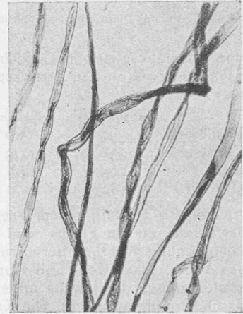
Abb. 8b. Baumwollfasern Vergrößerung 90 fach
