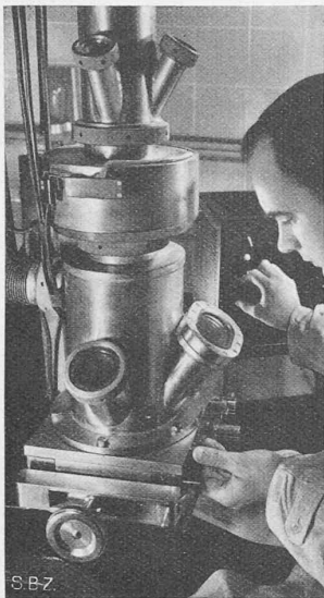
Abb. 4 (links). Elektronen-Uebermikroskop von Siemens
