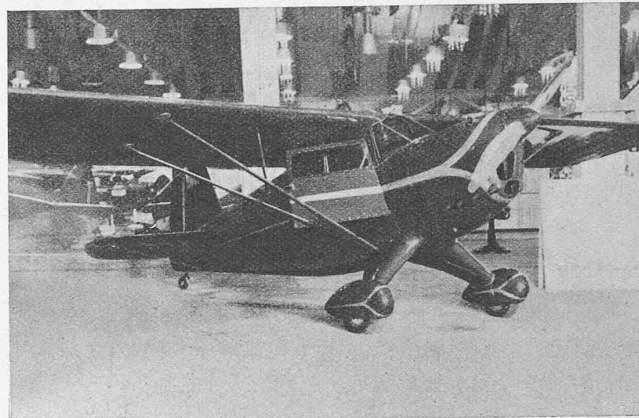
Abb. 2. Tandem-Zweisitzer Rearwin Speedster. Spannweite 9,8 m, Länge 6,7 m, 150 PS, v = 260 km/h, Steigfähigkeit 7,1 m/sec, Nutzlast 300 kg
