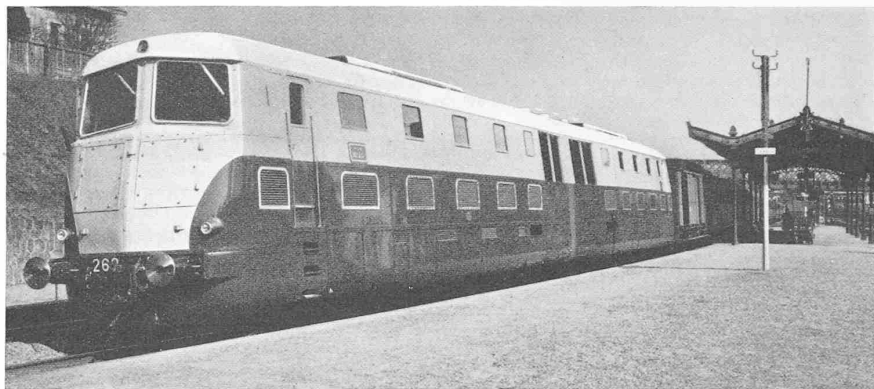
Abb. 18. 2C,2 + 2C,2 Dieselelekt. Lok. der S. N. C. F. (Sud-Est) von Fives Lille mit Sécheron
