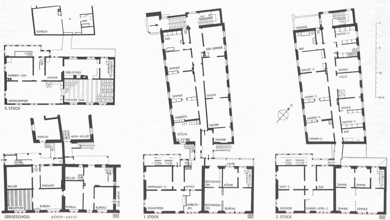
Abb. 1 bis 4. Grundrisse der Häuser Schanzenhof und Weltkugel, samt rückwärtigem Gartenflügel. — Masstab 1 : 400
