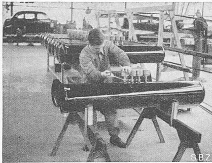
Abb. 5. Montage der Elektroventile auf der Entwicklerkammer
