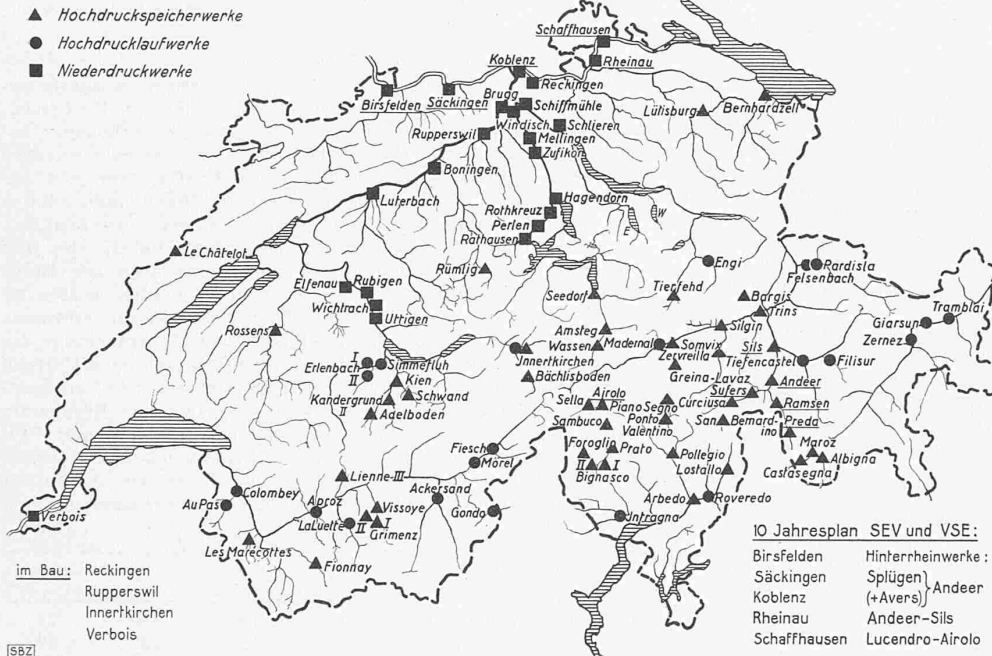
Projektirte ausbauwürdige und im Bau befindliche Wasserkraftwerke der Schweiz von min. 5000 kW Ausbauleistung, Speicherwerke mit Winterenergie-Gestehungspreisen von max. 6 Rp./kWh. Nach einer Zeichnung der «Schweiz. Wasser- u. Energiewirtschaft», von uns ergänzt
