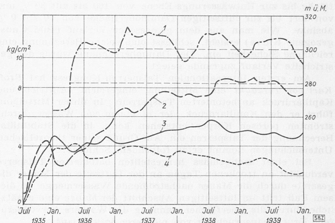
Bild 6. Gemessene vertikale Druckspannungen in der Basisfläche des Norris-Dam in Abhängigkeit des zeitlichen Verlaufes der Füllung. 1 Füllungshöhe, 2 Druckspannungen nahe der luftseitigen Oberfläche, 3 dasselbe nahe Wasserseite, 4 Druckspannungen in Mauermitte
