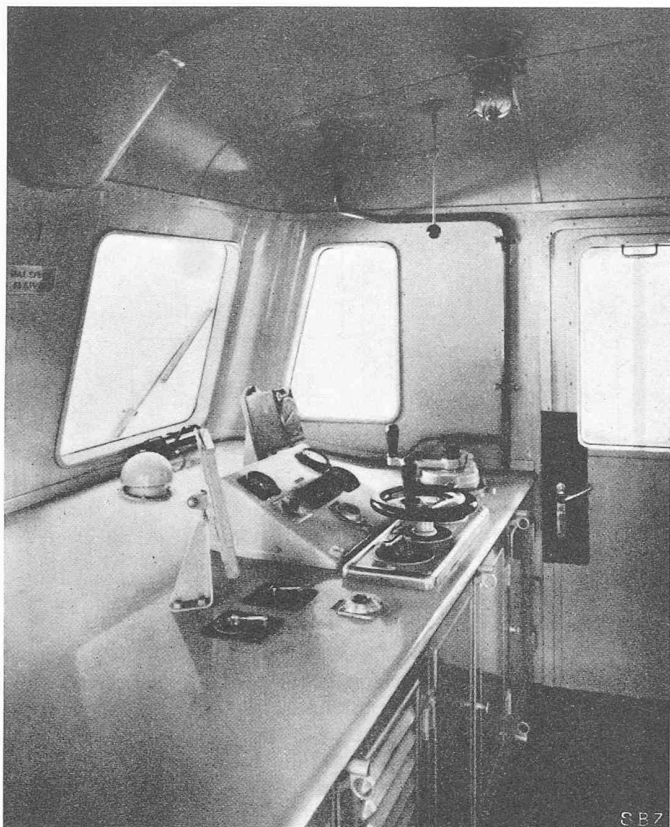
Bild 16. Führerstand der Diesel-elektrischen Thailand-Lokomotive
