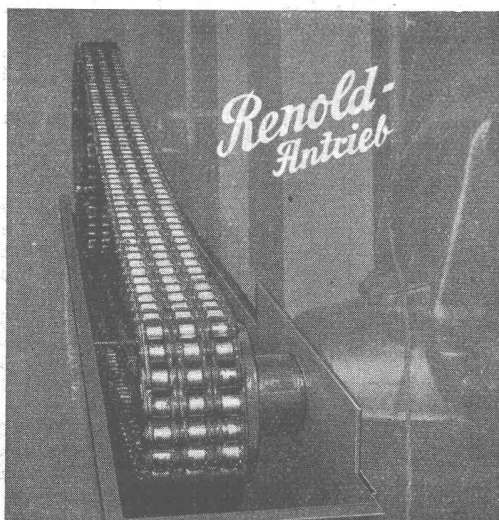
eines „Holländers“, 150 PS, bei 435/116 T. p. M.
