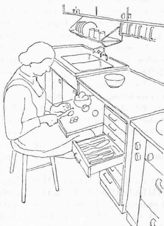
Bild 4. Der Arbeitstisch mit zwei verschieden hohen Arbeitsflächen — eine für stehendes Arbeiten und eine zum Arbeiten in sitzender Stellung
