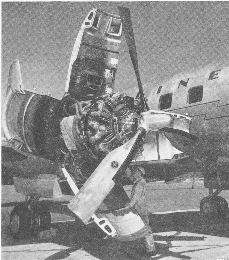
Bild 3. Motorgondel mit aufgeklappter Verschaltung
