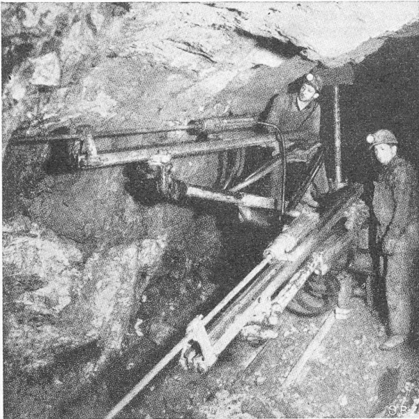
Bild 6. Leichter Bohrwagen mit langen Auslegern und langen Lafetten
