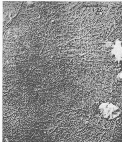
Bild 2. Flachsfaser Streuungstextur der Primärwand
