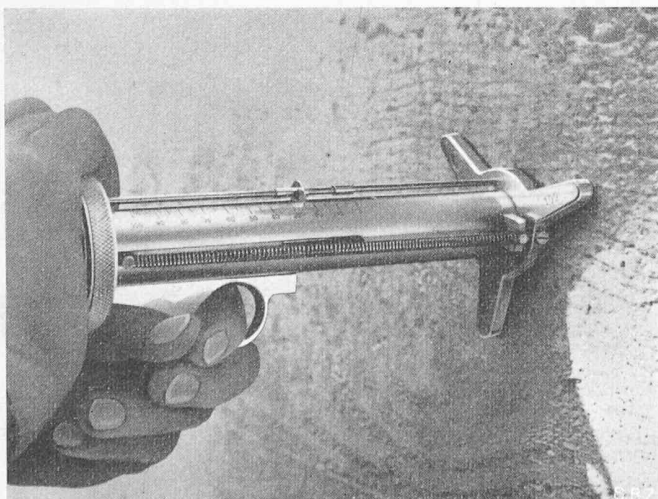
Bild 1. Der Beton-Prüfhammer im Gebrauch
