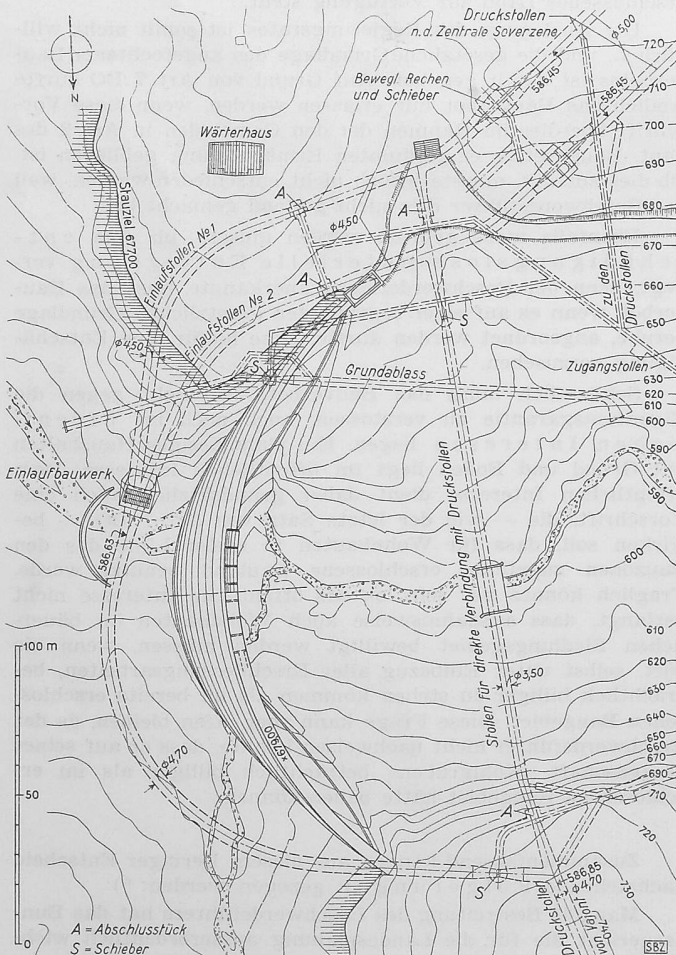
Bild 20. Staumauer Val Gallina, Lageplan, Masstab 1:2500
