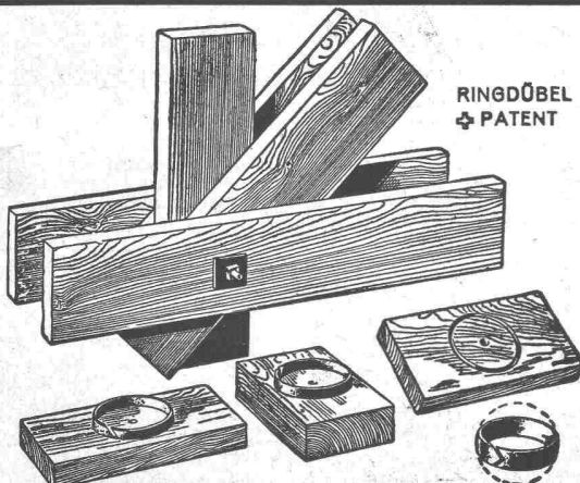
Knotenpunktverbindung für hölzerne Tragwerke
