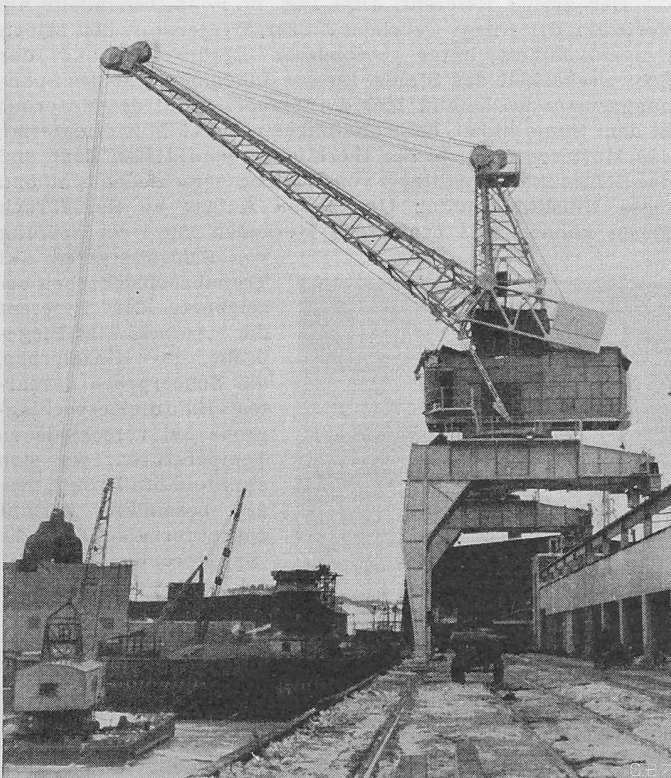
Bild 34. Halbportalkran mit Ausleger aus Aluminium von 4,5 t Tragkraft im Hafen von Port Alfred
