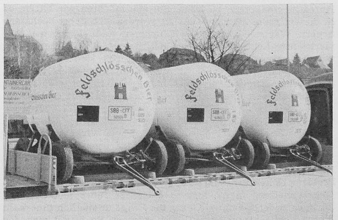
Bild 9. Die «Feldschlösschen»-Behälter werden an Seitenrampen auf gewöhnliche Plattformwagen verladen.
