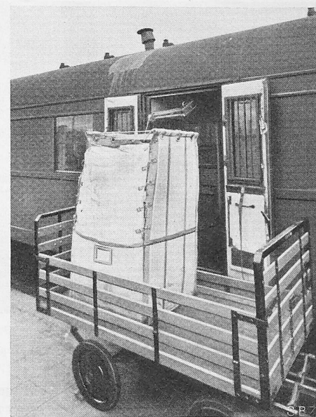
Bild 17. Durch die Einführung von Post- und Gepäckbehältern können die Aufenthalte der Züge auf Unterwegsbahnhöfen verkürzt werden.
