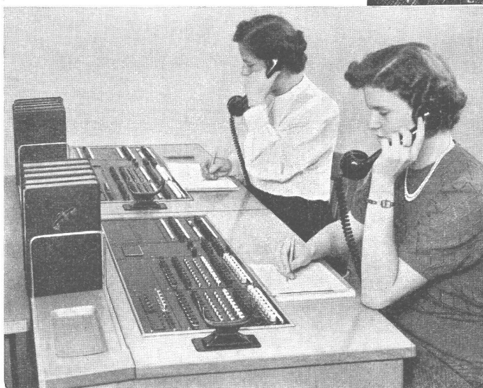
Neue schnurlose Vermittlungseinrichtung mit Zahlgeber für Telephonanlagen mit 20 Amtsleitungen.
