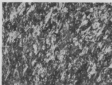
Bild 15. Mikrogefüge im aufgestauchten Kopf des pat., gez. Stahldrähtes
