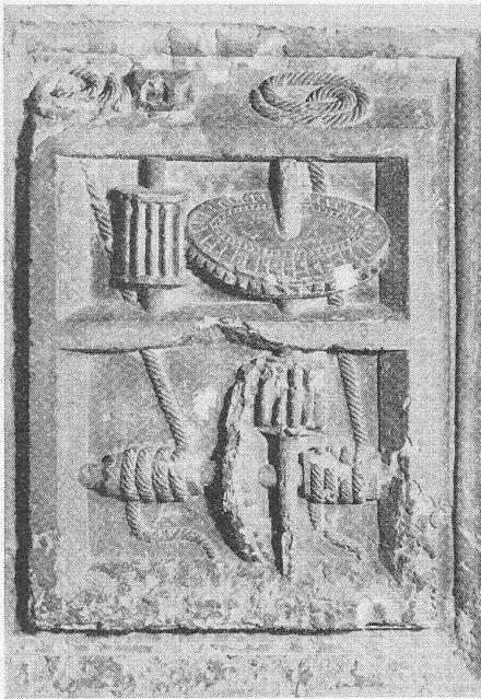
Bild 1. Hebezeug. Der Antrieb erfolgt durch Drehen des gelochten Holzblocks links oben mittels kreuzweise durchgesteckter Stangen. Die Gesamtübersetzung der doppelten Triebstockverzahnung beträgt etwa 1:9.
