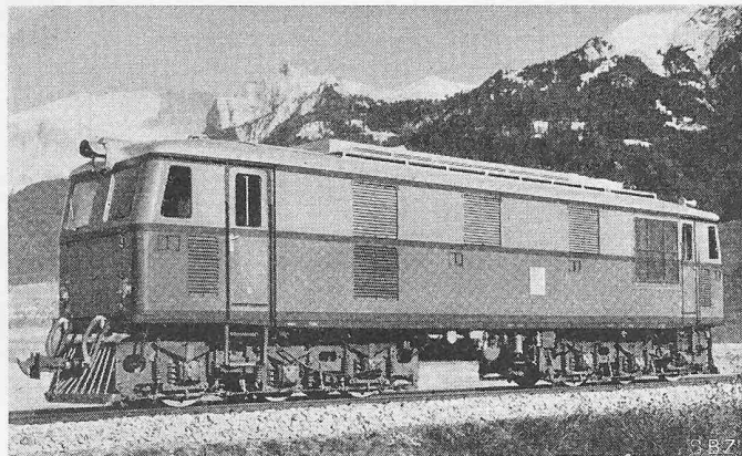
Bild 11. Dieselelektrische Lokomotive von 960 PS der Siamesischen Staatsbahnen
