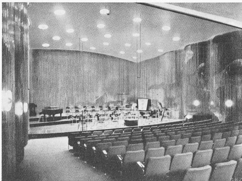
Bild 3. Konzertstudio des NWDR in Hannover. Ueber der gewellten Wandverkleidung aus Holz sind Messingflächen (zum Teil glatt, zum Teil perforiert) angebracht.
