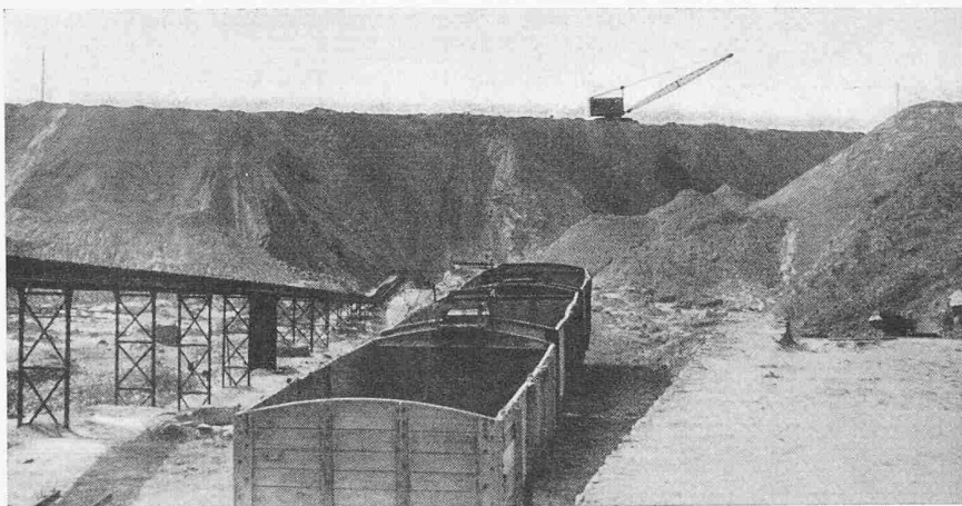
Bild 2. Grube Jemepp bei Charleroi. Quarzsand mit rd. 80 % \text{SiO}_2 und 20 % Ton. Schichthöhe etwa 25 m
